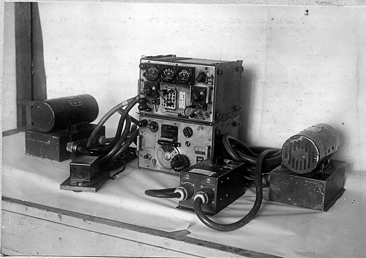
Фото № 6 — Радиостанция самолета Мицубиси "P-100".
